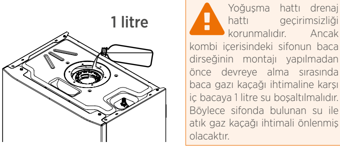
Şekil 18 Yoğuşma sifonunun doldurulması
