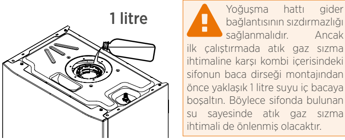
Şekil 15 Yoğuşma sifonunun su ile doldurulması
