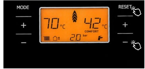
Şekil 47 Hava tahliye fonksiyonunu aktif hale getirmek için reset ve sıcaklık azaltma butonuna basma.
